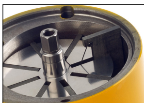
Moteur à palettes multiples à ressort
